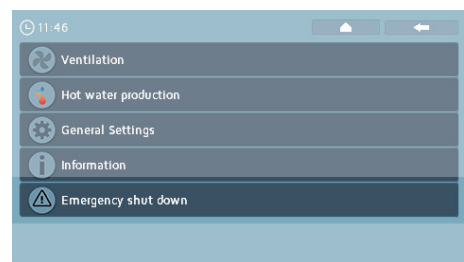
2. Tryk på "Nødstop ventilation"
