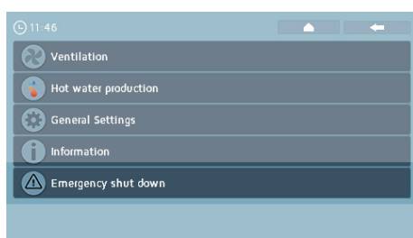
5. Når faren er overdrevet, og det igen er muligt at ventilere, trykkes der endnu en gang på "Nødstop ventilation"
